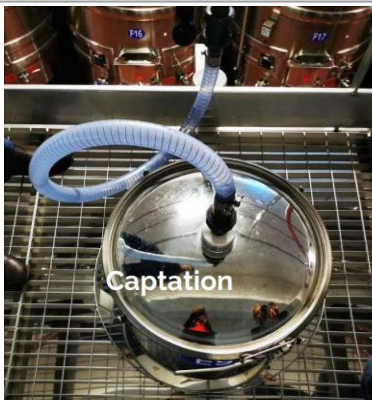
Photo 1 : Système de captation du CO 2 de fermentation
